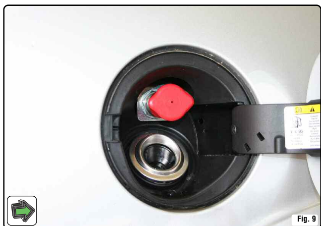
Effettuare un foro nel rivestimento in plastica del bocchettone benzina, per l'inserimento dell'innesto metano (fig. 9).
