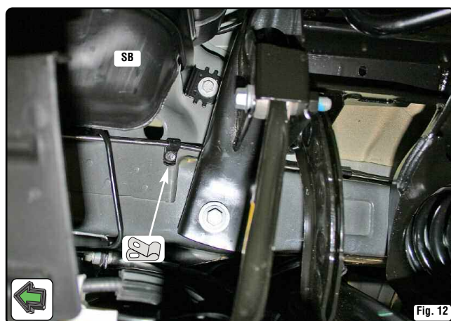
Proseguire passando a destra del serbatoio benzina [SB] (figg. 12 e 13).
