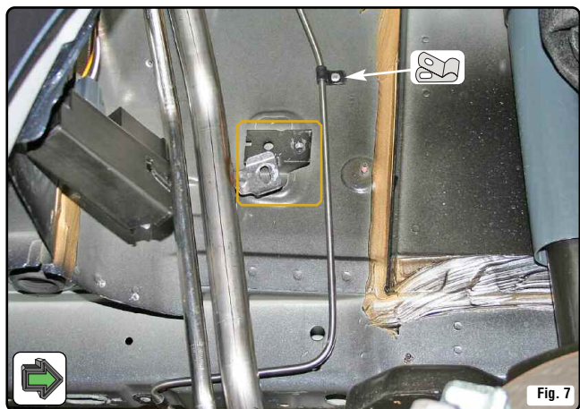
Svitare temporaneamente il fissaggio della tubazione di rifornimento benzina (riquadro arancione), per permettere la stesura della tubazione acciaio.
