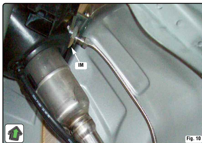
Bloccare l'innesto metano [IM] alla staffa precedentemente installata, utilizzando l'apposito dado. Raccordare la tubazione acciaio sull'innesto (fig. 10).
