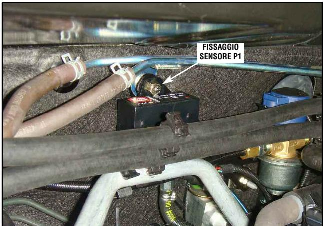
Fissare il sensore P1 al prigioniero presente sulla paratia motore della vettura, corrispondente al fissaggio superiore della staffa dell'elettrovalvola.
