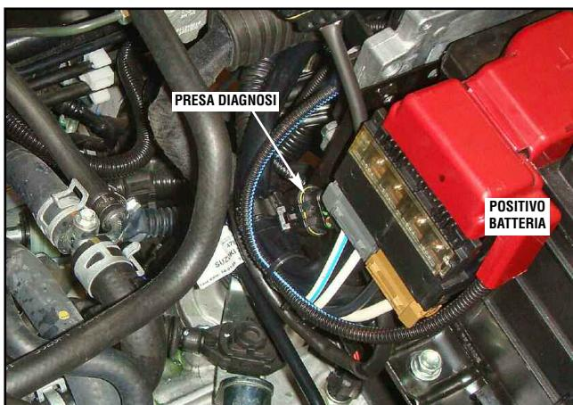
Fissare la presa diagnosi alla scatola batteria della vettura.
