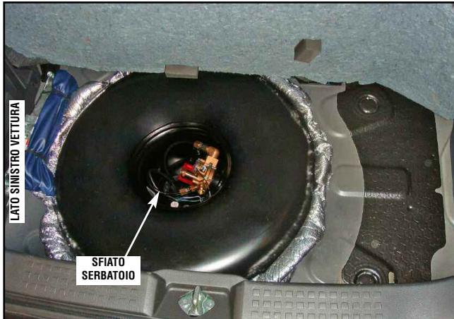
Montare la multivalvola sul serbatoio. Posizionare il foglio isolante ed il serbatoio nel vano porta ruota di scorta con la multivalvola rivolta verso il lato sinistro della vettura. Effettuare i fori per lo sfiato e per l'inserimento delle viti di fissaggio serbatoio. Fissare lo sfiato.
