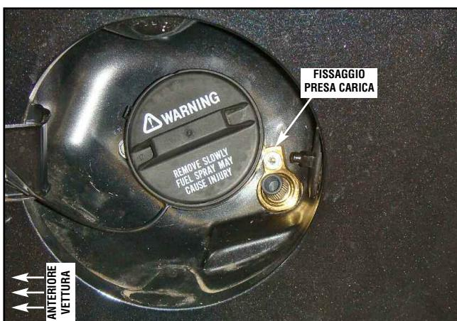
Installare la presa carica e raccordarvi la tubazione proveniente dal serbatoio.
