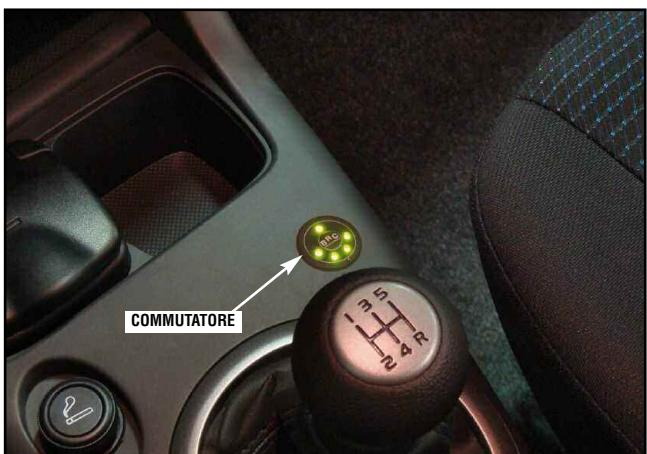
Installare il commutatore sul tunnel centrale della vettura, a fianco dell'accendisigari.
